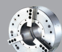
PB-ES 氣壓式動力夾頭 Pneumatic power chuck.
