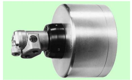
HH4C 形標準回転油圧シリンダに、圧力源の故障、配管部の損傷などにより供給圧力が異常に低下しても圧力を保持する安全対策用の逆止弁を内蔵しています。
