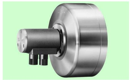
空気圧用の回転シリンダで作動が速く、長時間の酷使にも耐え、圧縮空気の消費量を著しく節減しきわめて経済的です。シリンダは強力軽合金製で、高速回転にも適し、豊和パワーチャックと併用すれば一段と高性能を発揮します。
